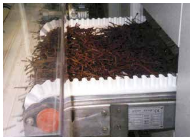
Trasporto con bordi di contenimento bastoncini di cioccolato
