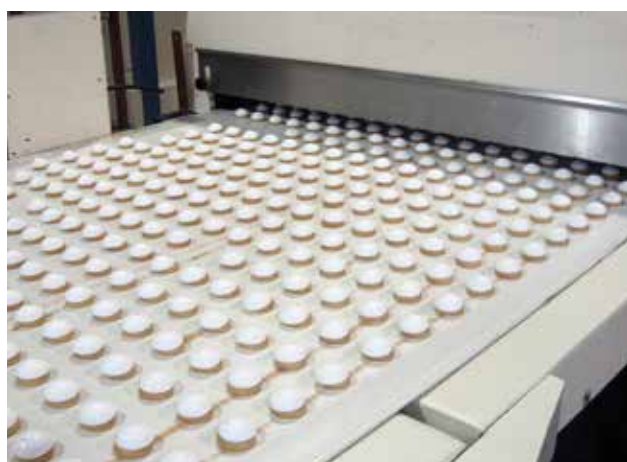
Alimentazione tunnel di raffreddamento
